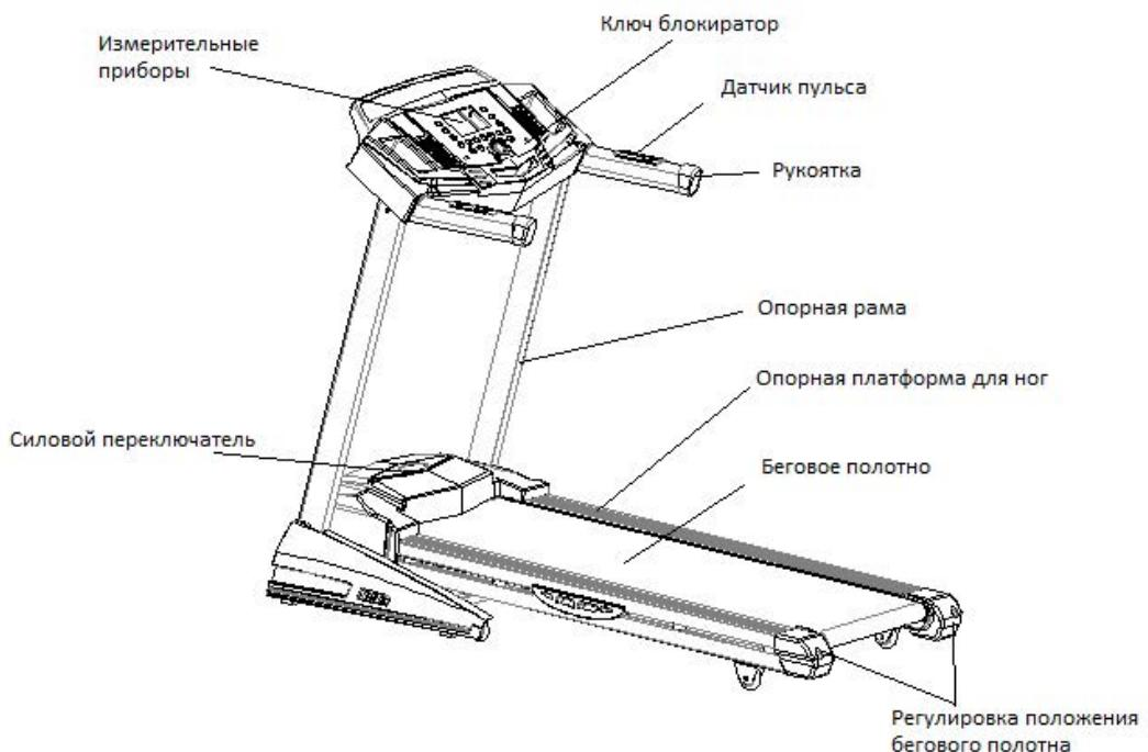
Рис.1 Электрическая беговая дорожка VF-4034
